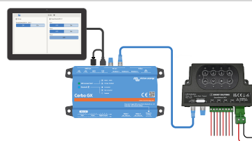
Przełącznik SmartSwitch DC4 podłączony na końcu sieci VE.Can
